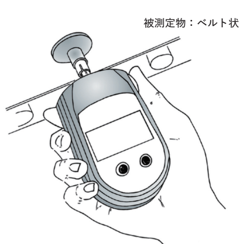
速度計測ホイールを取付けての速度計測
